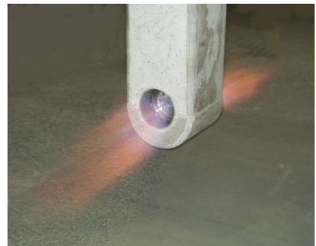
**MAPEKO TWIN BURNER** zur gleichmäßigen Beheizung in zwei Richtungen. Der Brenner taucht vertikal bis zur Pfannenmitte ein.
